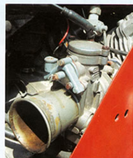
The 36mm pumper Dell'Orto carbs fuel the race-spec Guzzi.
